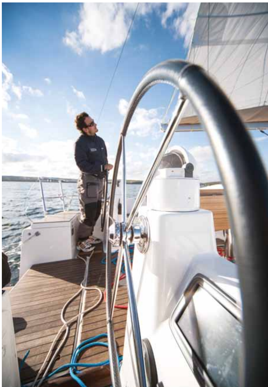
Koła sterowe zamontowano na kolumnach połączonych z kokpitowymi siedziskami.
