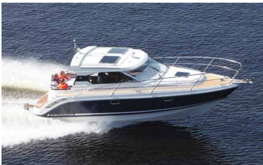
Podczas testów jacht wyposażony w silnik o mocy 370 KM rozpędził się do 42 węzłów.
